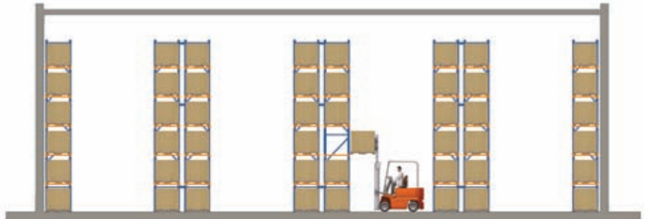
Sistema con racks selectivos
