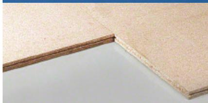
Formado por tableros de madera aglomerada de 30 mm de espesor que se unen entre sí mediante empalmes o por encaje mediante machihembrados. Una vez colocados los tableros, el piso presenta una superficie lisa sin acabado superficial. Una variante es el suelo con tablero ignífugo, tratado contra la propagación del fuego y con clasificación M1.
