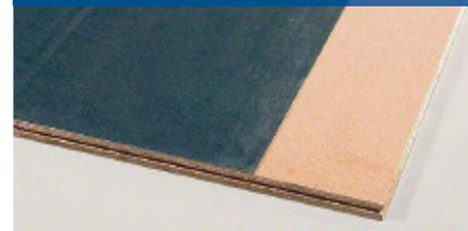
El piso de tablero aglomerado de madera puede recubrirse con chapa galvanizada de 1,5 mm de espesor cuando sobre el entrepiso vaya a circular algún tipo de patín hidráulico o carro pesado y quiera evitarse el desgaste del tablero, así como minimizar el ruido del desplazamiento.
